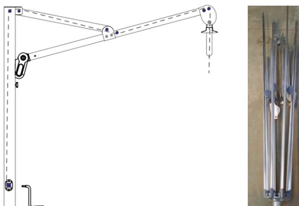
7. Devissez l'axe des baleines à changer avec un tournevis cruciforme au sommet et une clef plate, puis retirez l'axe
