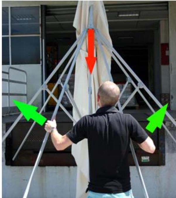
9 - Retirer la toile ancienne et préparez la nouvelle en prenant le soin de la positionner de façon à ce que la sangle de maintien qui est cousue sur la toile soit placée de façon à se retrouver sur la partie avant et pouvoir ensuite se placer en mettant les scratches à l'arrière du mât principal.
